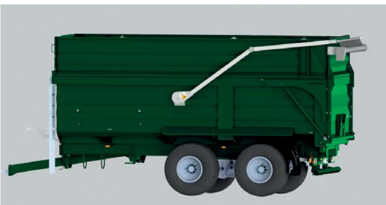
Flexcover Vario - Führung oberhalb der Heckklappe
