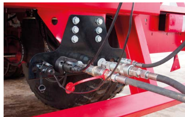
Anschluss an die Anhängerhydraulik
